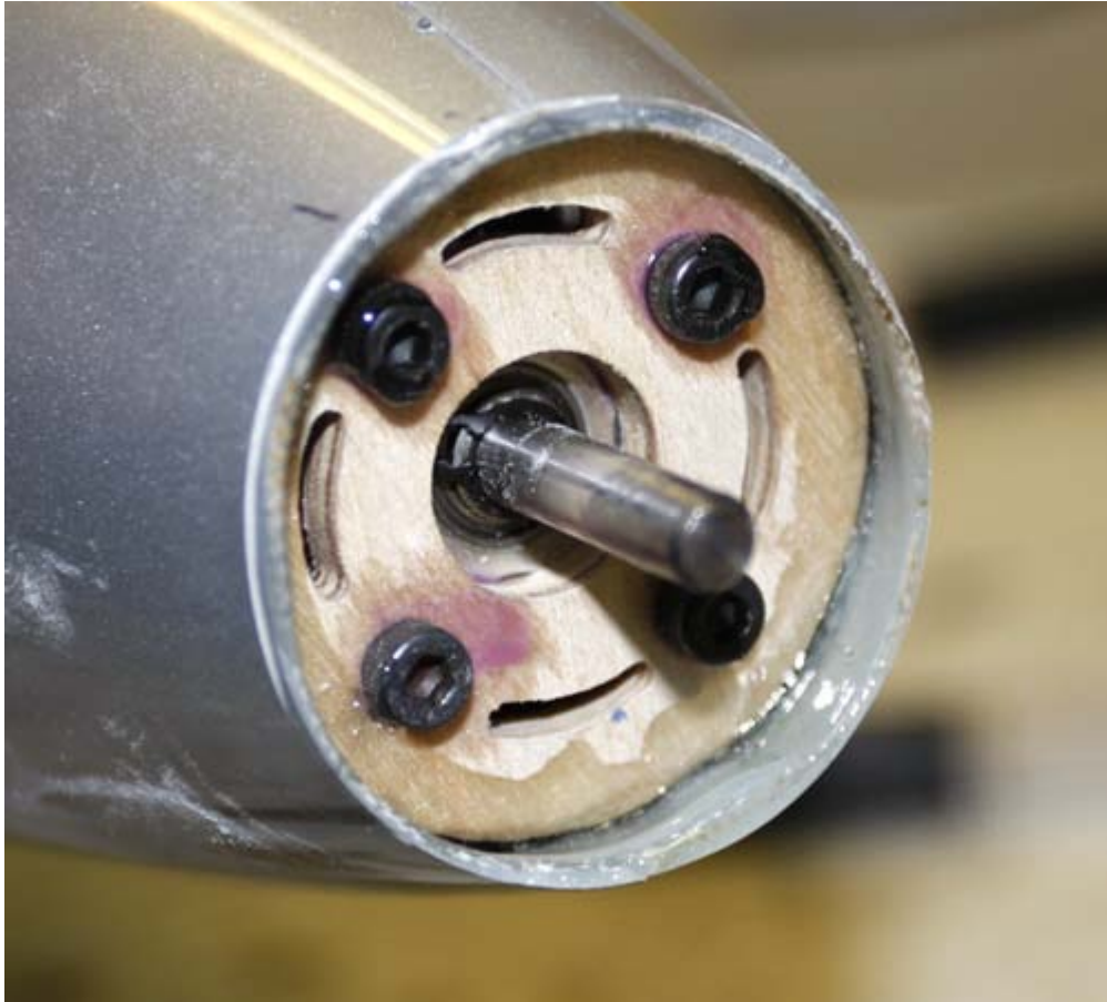
Forkanten må slipes ned og tilpasses spinner og klappropell
