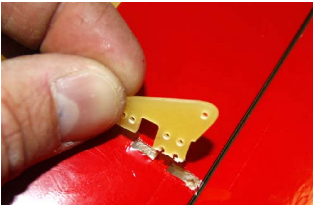
Det er forskjell på balanse og flapsror hornene. Dette er balanserorshornene
