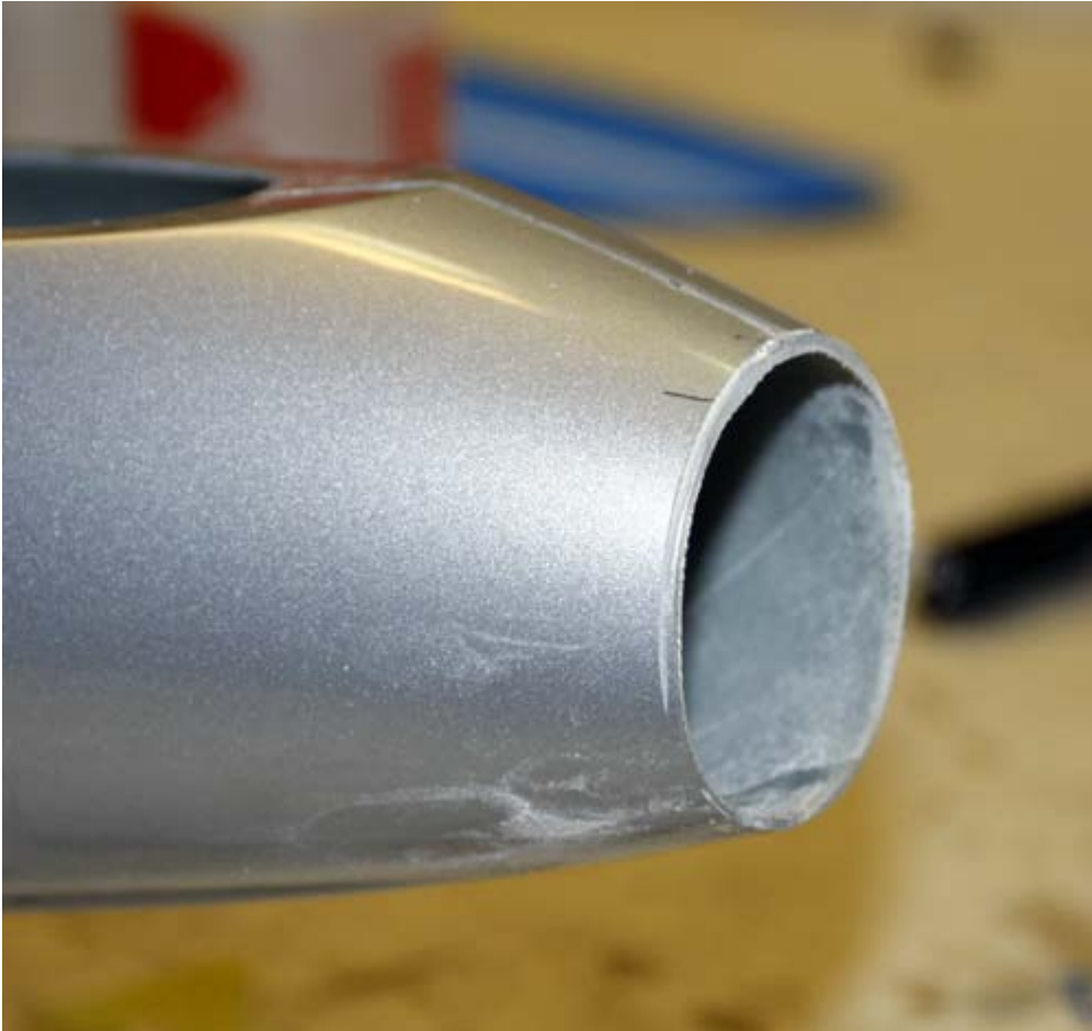
Her er nesa kappet av og skal tilpasses Hyperion motoren
