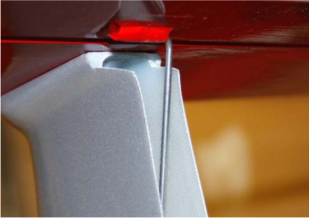
En plastylse limes til høyderoret med CA og "låses" med film
