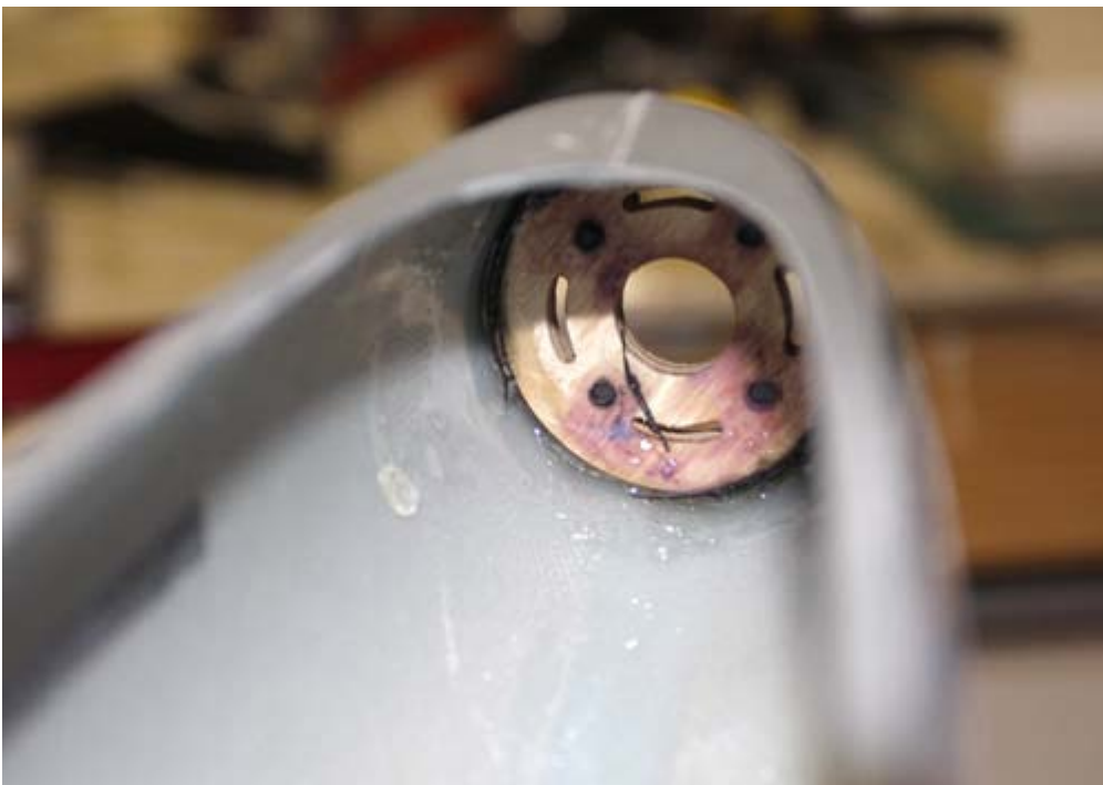
Spantet er limt inn på plass
