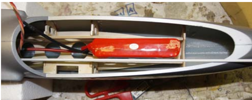
Vuggen er innlimt, ikke mye mer plass på dette 3S batteriet
