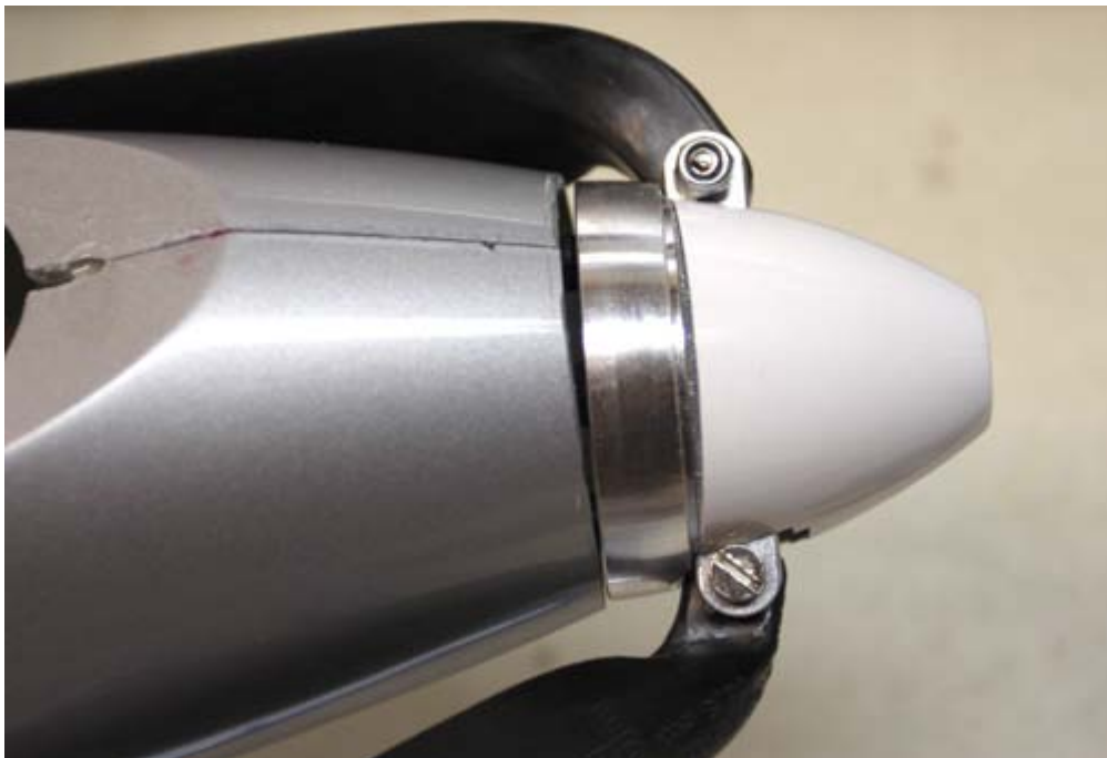
Det nærmer seg akseptabel glippe, litt småsliping igjen
